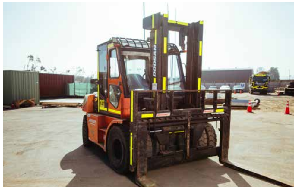
GRÚA HORQUILLA DOOSAN D70 S-5 CAPACIDAD: 7 TONELADAS
