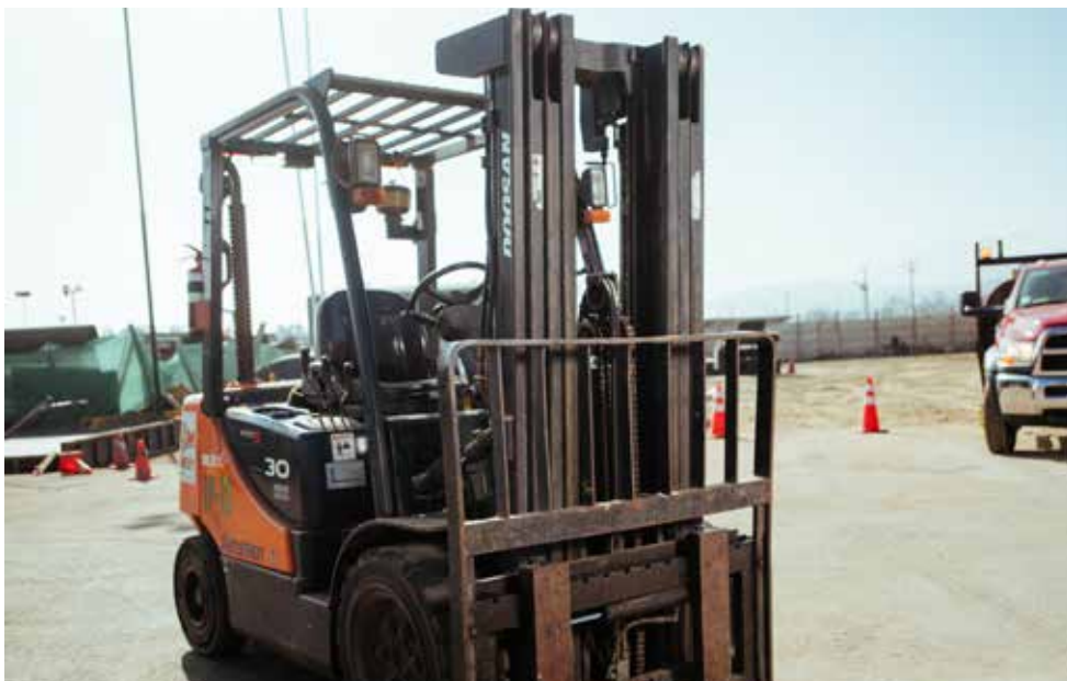
GRÚA HORQUILLA DOOSAN D30 S-5 CAPACIDAD: 3 TONELADAS
